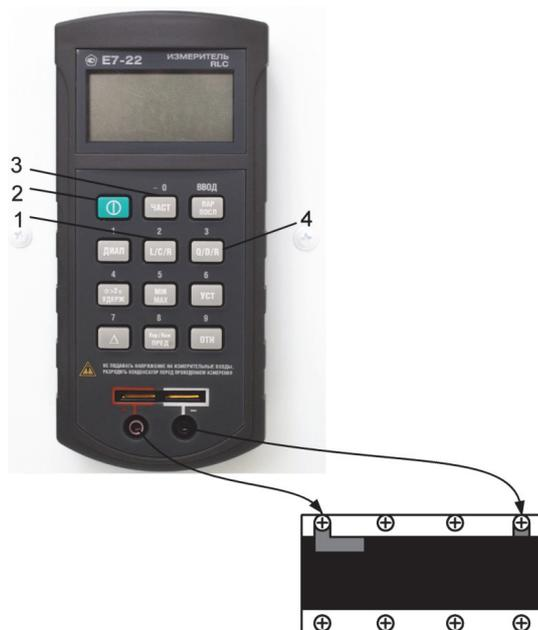
Рис. 2. Соединение измерителя  $RLC$  и модели конденсатора
