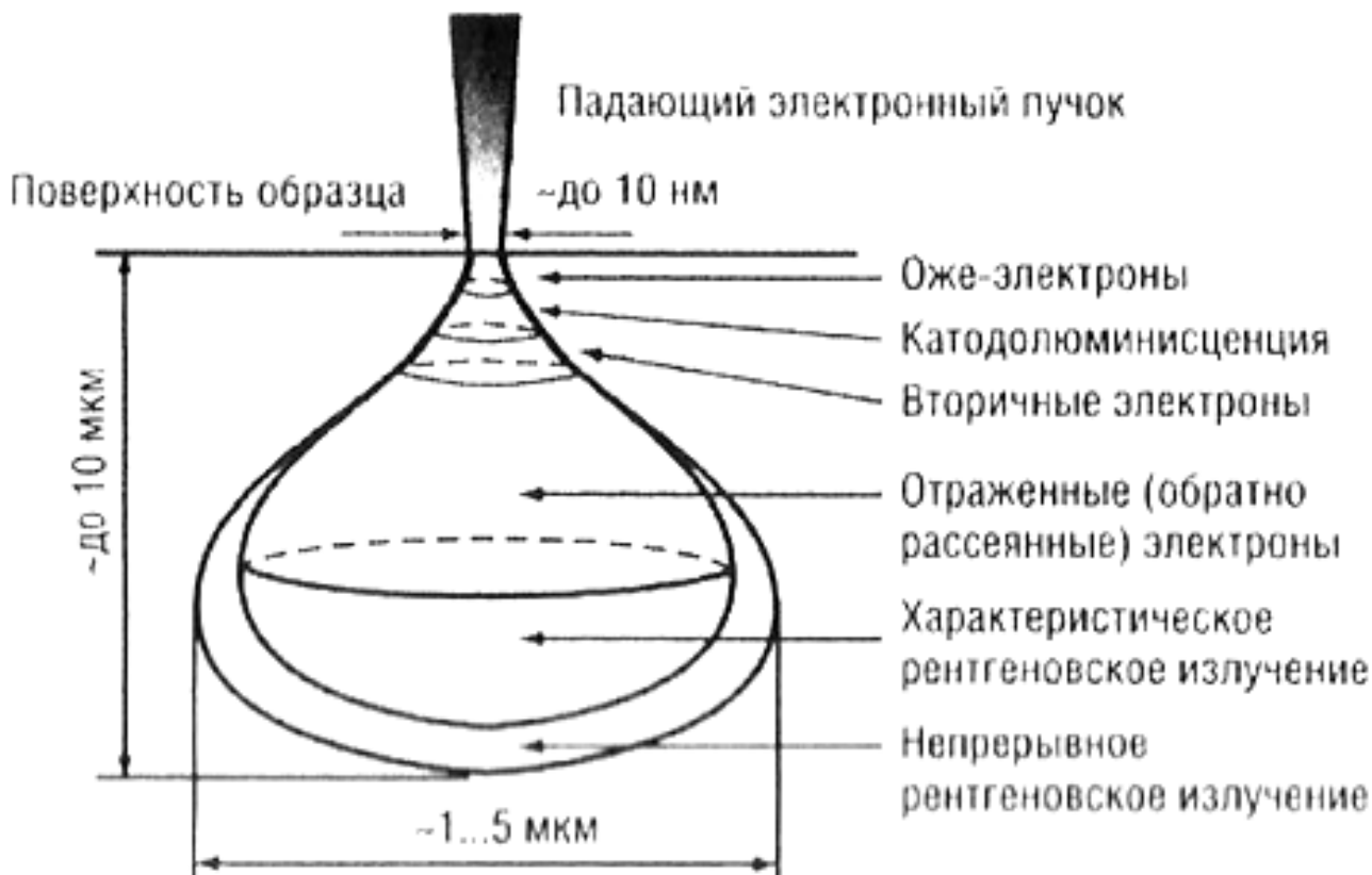
Рис. 1. Зона взаимодействия электронного пучка с объектом
